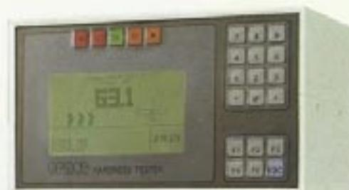
von Prüfparametern zur Verfügung. Für den Ausdruck des Prüfprotokolls stehen fünf verschiedene Sprachen zur Verfügung. Wie bei allen unseren Geräten, so wird auch beim TWIN das Prüfergebn durch Federn oder Durchbiegen des Werkstückes nicht verfälscht. Die Werkstücke können überhängend in das Stativ eingespannt werden, und benötigen keine zusätzliche Stütze.
