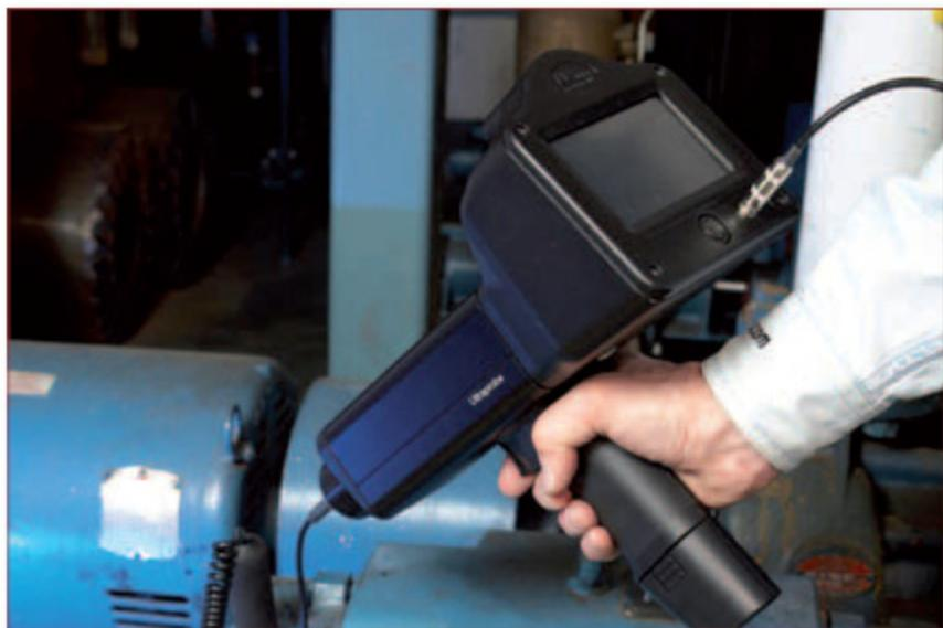
Mnohdy je vhodné znát teplotu zkoumaného objektu. Už není třeba s sebou nosit přídavný teploměr. Ultraprobe® 15000 má vestavěný bezkontaktní teploměr s teplotním rozsahem od -20 do 500 °C. A navíc je vybavený bodovým laserovým zaměřovačem, aby bylo patrné, na kterou část měřeného objektu byl teploměr zamířený. Teplota se pohodlně odečítá spolu s ostatními údaji na displeji přístroje.
