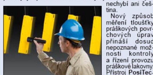
Nový způsob měření tloušťky práškových povrchových úprav přináší dosud nepoznané možnosti kontroly a řízení provozu práškové lakovny. Přístroj PosiTector PC umožňuje nejen rychle zjistit tloušťku vytvrzené práškové vrstvy, ale umožní ve zpětné vazbě řídit proces nanášení práškové barvy. A to přináší nejen časovou úsporu kontrolního procesu, ale také úsporu materiálu a zlepšení kvality technologického procesu.
