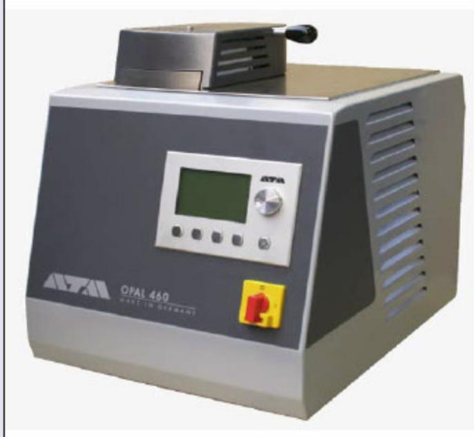
chladičí vody, čímž je provoz lisů Opal šetrný k životnímu prostředí. Teplotní rozsah zalévání je nastavitelný od 20 do 200 °C při tlaku do 160 bar. Lisem Opal 460 je možno zalévat vzorky od průměru 25 mm do 50 mm, lisem Opal 480 pak až do průměru 70 mm. K dispozici jsou také speciální komory obdélníkového tvaru do rozměru 40 x 60 mm. Lisy Opal jsou kompaktního robustního provedení, vybavené spolehlivým hydraulickým agregátem, zkonstruované převážně z hliníkových slitin.
