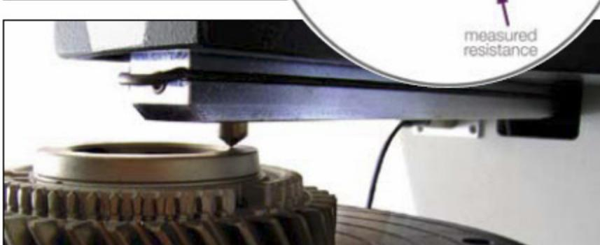
mikrotvrdost na řezu od povrchu do hloubky materiálu. Předpokládejme, že vyříznutí vzorku z kontrolovaného dílu trvá 10 minut a jeho metalografické zpracování také 10 minut. Na změření mikrotvrdosti v 10 bodech musíme počítat nejméně 25 minut včetně stanovení výsledného grafu závislosti tvrdosti na hloubce. Tak se dostaneme na optimistických 45 minut, a to nepočítáme
