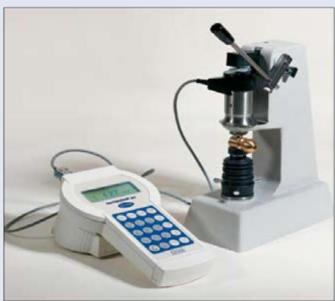
zální tvrdoměr Omnitest s kamerovým snímáním a programovým vyhodnocením výstupu umožňuje měření v rozsahu zatížení do 250 kg ve všech používaných jednotkách. Plně systémové tvrdoměry BRE-AUT jsou určeny pro aplikace na výrobních linkách, kde umožňují automatické měření až do zatížení 3000kg.
