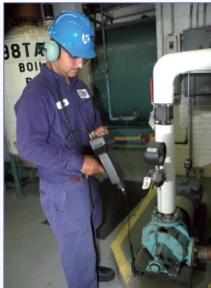
Obr. 2: Ultraprrobe 10 000 s magnetickým kontaktním modulem
