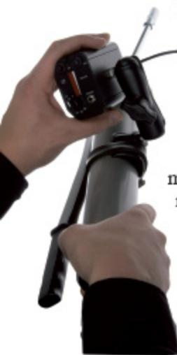
Obr. 1: Asistent mazání Ultraprrobe 201
