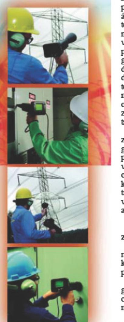
detektoru můžeme také poměrně přesně lokalizovat místo výboje na elektrickém zařízení. Ultrazvuk také poskytuje možnost kvantifikovat emisní charakter pomocí spektrální analýzy, a to umožňuje další důkladnou diagnostiku.
